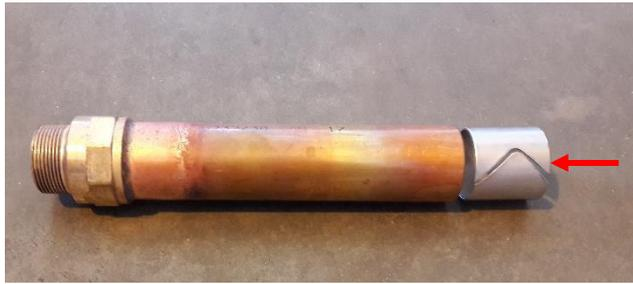
**Abbildung 58:** Kupferrohr mit Verstärkungsring
