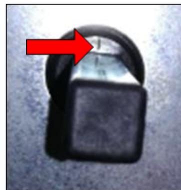
**Abbildung 44:** Schließstellung, gekennzeichnet durch eine Markierung am Zahnrad
