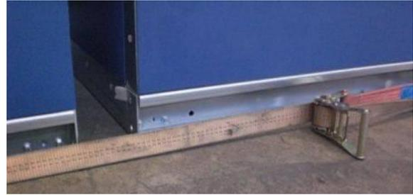
**Abbildung 24:** Geräteteile zusammenziehen (Detail)
