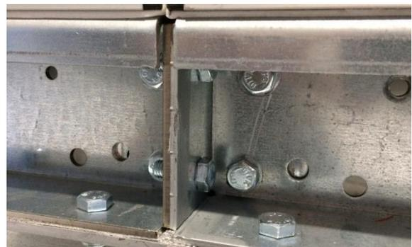
**Abbildung 26:** Verschraubung Grundrahmen
