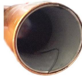
**Abbildung 59:** Kupferrohr mit eingesetztem Verstärkungsring
