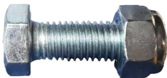
**Abbildung 25:** Sechskantschraube mit selbstsichernder Mutter M8x20/ M10x30/ M12x40
