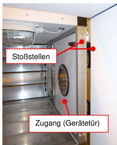
**Abbildung 36:** Über Gerätetür zugängliche Geräteteilung
