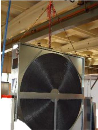
**Abbildung 85:** Anheben mittels Kettenzug
