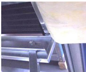
**Abbildung 46:** Filter einschieben
