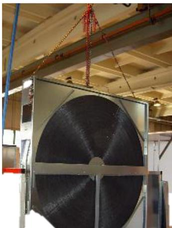
**Abbildung 247:** Anheben mittels Kettenzug
