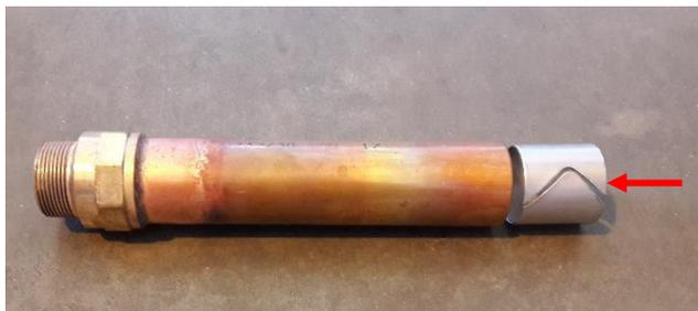
**Abbildung 176:** Kupferrohr mit Verstärkungsring
