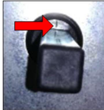
**Abbildung 146:** Schließstellung, gekennzeichnet durch eine Markierung am Zahnrad
