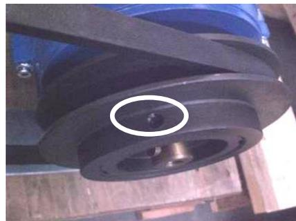
Abbildung 229: Position der Inbusschrauben an variablen Scheiben
