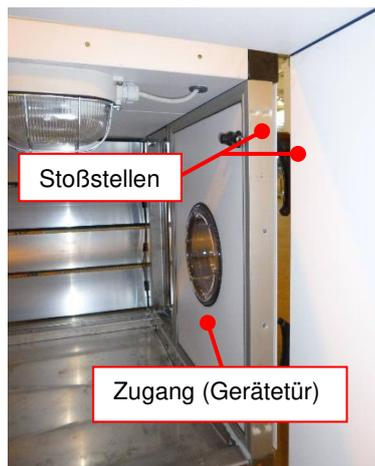
**Abbildung 101:** Über Gerätetür zugängliche Geräteteilung
