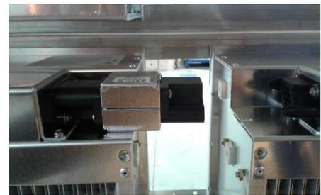
**Abbildung 170:** Steckverbindung elektrostatische Filter
