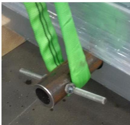
**Abbildung 27:** Sicherung gegen Abrutschen des Tragemittels
