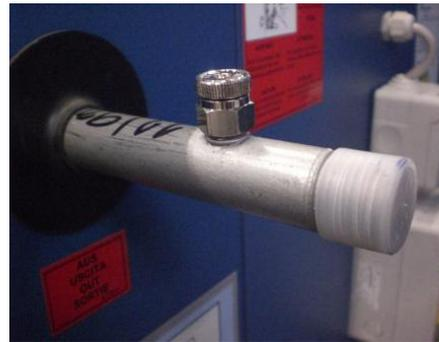
Abbildung 184: Entlüftungsventil
