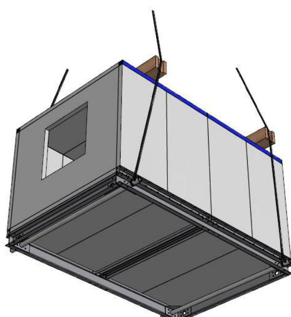
**Abbildung 26:** Gleichmäßige Belastung der Formrohre
