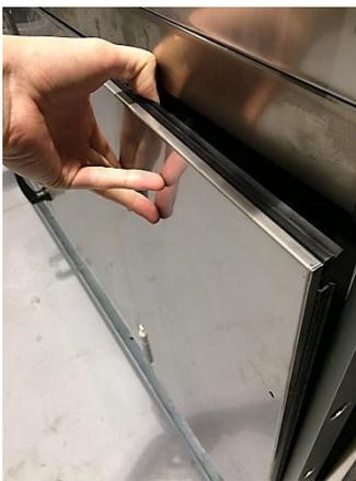
**Abbildung 95:** Einlegen des Außenpaneels
