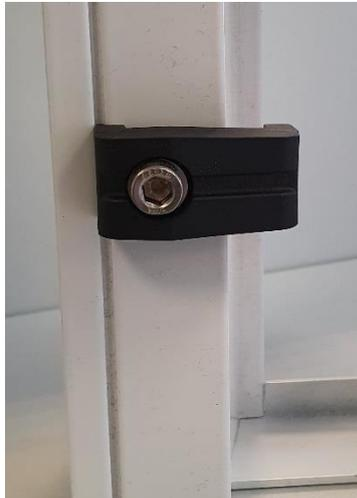
**Abbildung 141:** Befestigungsmechanismus an Türrahmen (ZIB)
