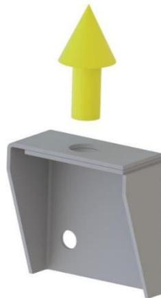
**Abbildung 48:** Vertikale Kräfteinleitung Montagelasche RLT-Deckengeräte
