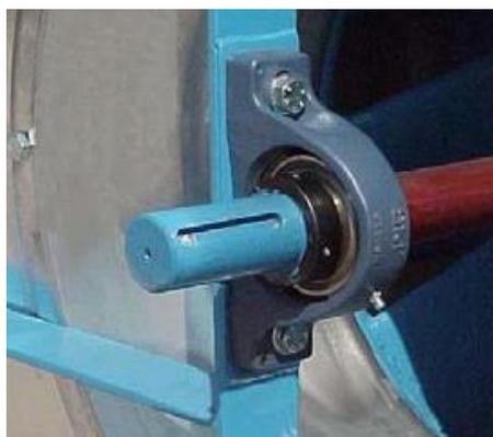
**Abbildung 231:** Ventilatorlager mit Schmiernippel (Bsp. Comefri NTHZ)
