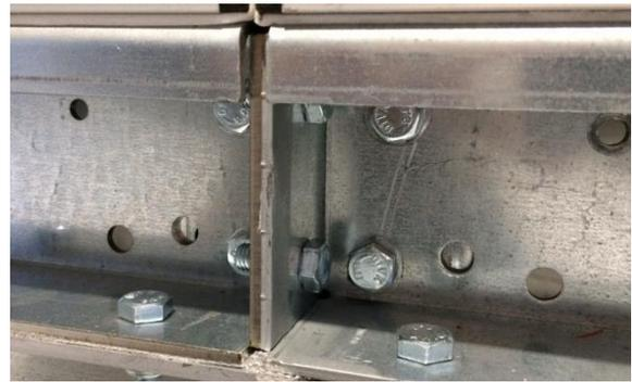
**Abbildung 64:** Verschraubung Grundrahmen
