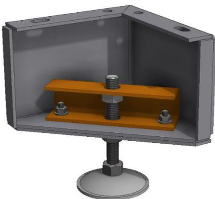
**Abbildung 41:** Höhenverstellbarer Gerätefuß mit Versteifung ohne Gummiunterlage
