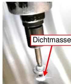
**Abbildung 109:** aufgetragene Dichtmasse (Sikaflex)
