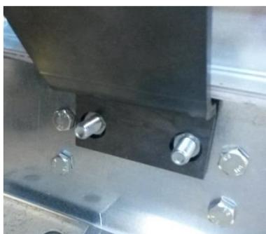
**Abbildung 29:** Monoblock-Kranlasche am Gegenrahmen positionieren
