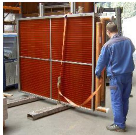
**Abbildung 248:** Sichern mittels Gurt
