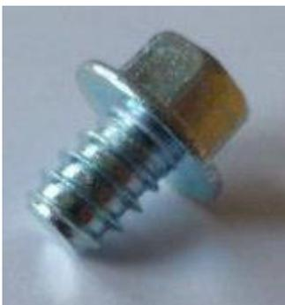
**Abbildung 75:** Stumpfe Blechschraube  $\varnothing 8 \times 11$
