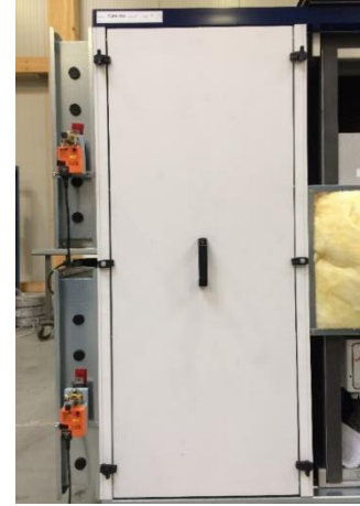
Figure 142: Fixed door panel (ZIB)
