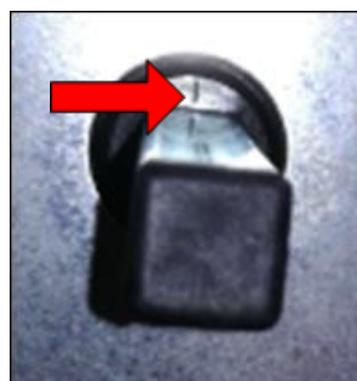
**Figura 44:** Posizione di chiusura, contraddistinto da una marcatura sulla ruota dentata
