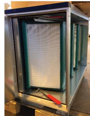
**Figura 51:** Sezione filtro con filtri inseriti
