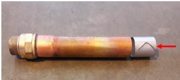
Figura 58: Tubo di rame con anello di rinforzo
