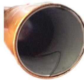
Figura 59: Tubo di rame con anello di rinforzo inserito
