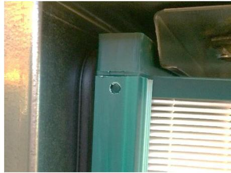
**Figura 53:** Controllare se il filtro poggia sul sigillo
