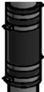
Figura 189: Morsetti montati
