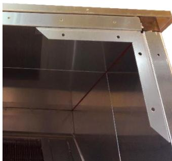
**Figura 70:** Angolo di montaggio
