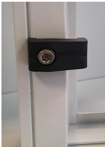
**Figura 141:** Meccanismo di fissaggio sul telaio della porta (ZIB)
