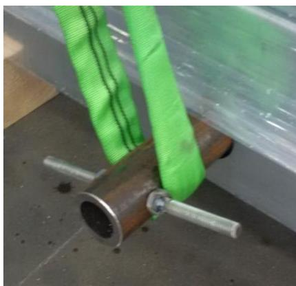
**Figura 27:** Messa in sicurezza degli elementi di sollevamento antislittamento
