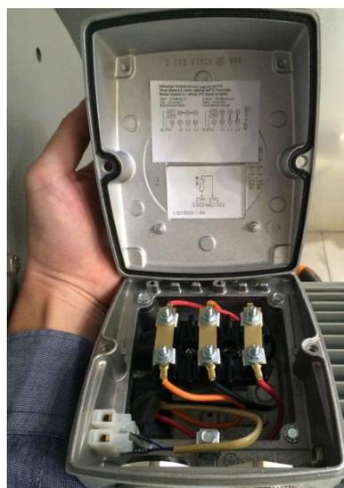
**Figura 205:** Morsettiera del motore
