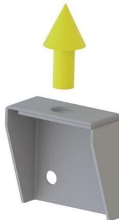
Figura 48: Trasmissione di forza verticale alle piastre di montaggio ZHK RECO
