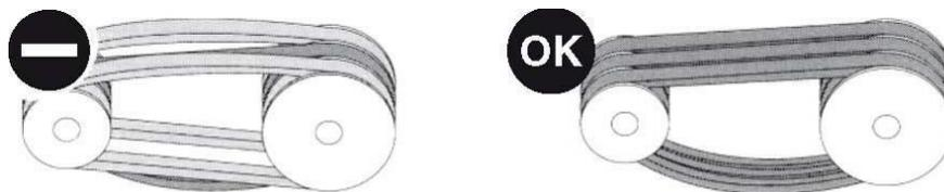
**Figura 239:** Pulegge con scanalature multiple - applicazione della cinghia
