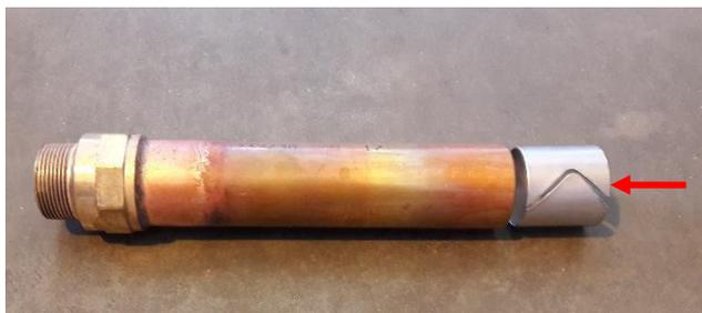
**Figura 176:** Tubo di rame con anello di rinforzo
