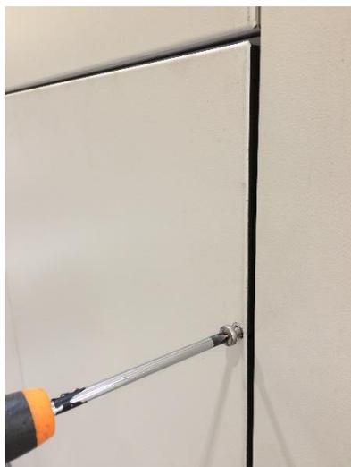
**Figura 138:** Staccare il pannello della porta (TRA-E) dal telaio della porta
