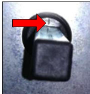
**Figura 146:** Posizione di chiusura, contraddistinto da una marcatura sulla ruota dentata
