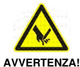
Durante i lavori sull'UTA ed al suo interno (o sulle sue parti) sussiste il rischio consistente di infortuni da taglio a causa da lamiere taglienti e spigoli vivi, come quelle delle coperture, le lamelle degli scambiatori di calore, angoli e spigoli. Utilizzare un dispositivo di protezione individuale: indumenti protettivi integrali, guanti e calzature protettive.
