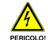
Folgorazione causate da parti sotto tensione quali motori elettrici, convertitori di frequenza, resistenze elettriche etc.
