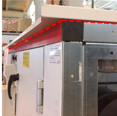
**Figura 111:** Chiudere le fughe con sigillante
