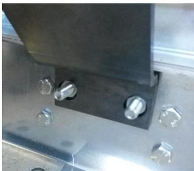
**Figura 29:** Posizionare il gancio della gru monoblocco sul controtelaio
