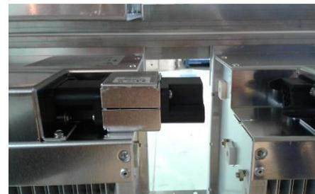
**Figura 170:** Connessione a spina dei filtri elettrostatici
