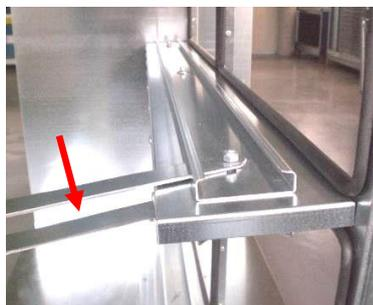
**Figura 152:** Allentare il dispositivo di fissaggio
