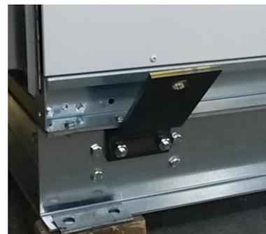
**Figura 31:** Cinghia per gru montata sul monoblocco
