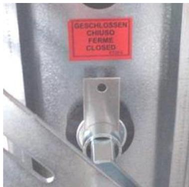
**Figura 145:** Posizione di chiusura, contraddistinto da un indicatore di posizione in lamiera
