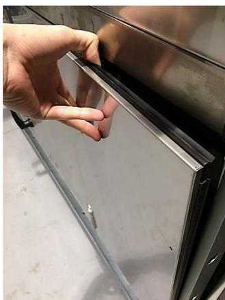
**Figura 95:** Inserire il pannello esterno
