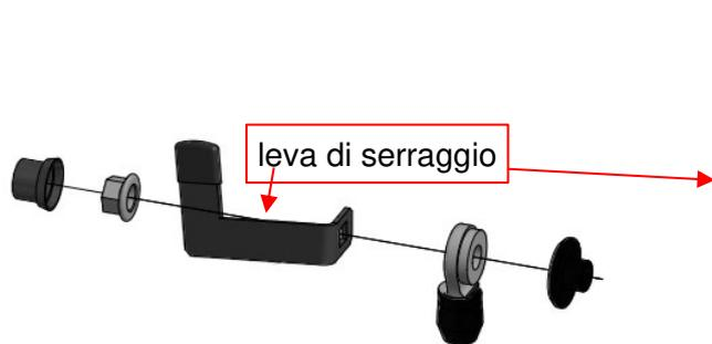
**Figura 143:** Costruzione di sicurezza: leva di serraggio
