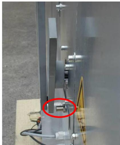
Figura 244: Posizione del sensore
