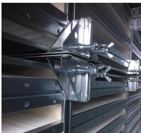
**Figura 165:** Dispositivo di serraggio con piastra di pressione di lamiera
