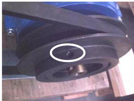
**Figura 229:** Posizione delle viti Allen su una puleggia a passo variabile
