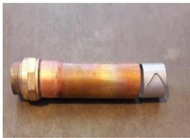
**Abbildung 7:** Kupferrohr mit Verstärkungsring
