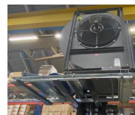
**Abbildung 3:** Verheben mittels Stapler/Hubwagen
