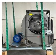
**Abbildung 2:** Verheben mittels Kran/Gurt
