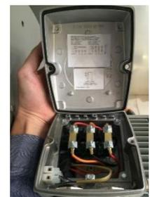
**Abbildung 17:** Motor-klemmkasten
