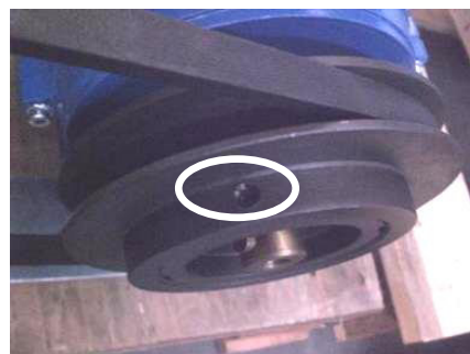
Figur 220: Posisjonering av Allen-skruene på justerbare trinser
