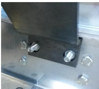
Figur 25: Posisjonering av løftefester på monoblokk, på motrammen
