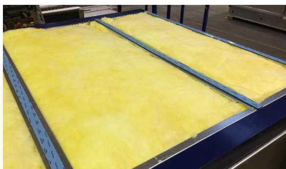
Figur 101: Del av enheten klargjort for montering av metallplatetak
