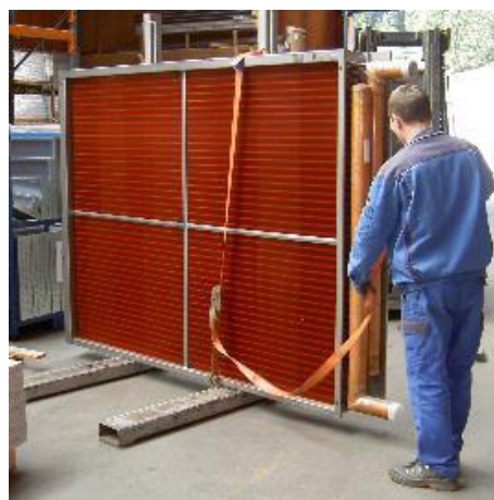
Figur 239: Sikring med belte
