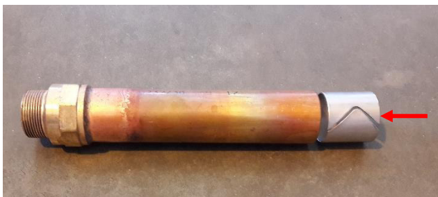
Figur 169: Kobberrør med forsterkningsring
