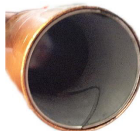
Figur 170: Kobberrør med innsatt forsterkningsring
