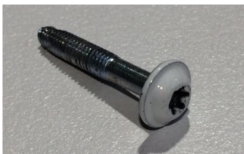
Figur 78: Selvtappende panhodeskrue TORX 25 \varnothing 4 \times 25
