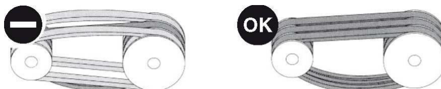
Figur 230: Trinser med flere spor – festing av beltene
