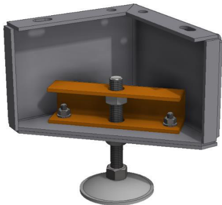
Figur 35: Høydejusterbar enhetsfot med avstivere uten gummibunn
