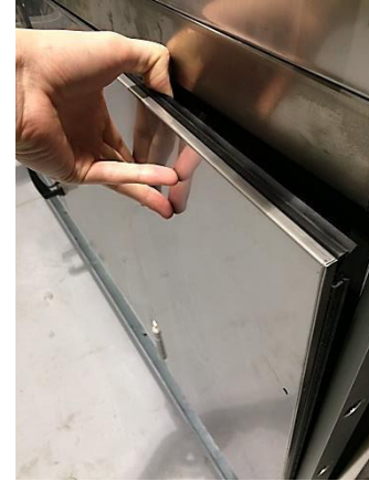
Ilustrație 55: Îndepărtare panouri exterioare
