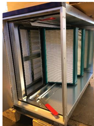
Ilustrație 149: ia în considerare comanda în funcție de rasterul cadrului filtrului
