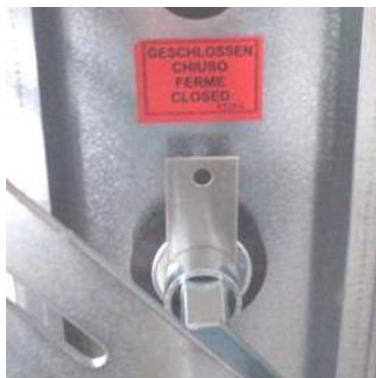
Ilustrație 137: Poziția închisă, caracterizată printr-un indicator de poziție din tablă
