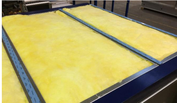
Ilustrație 100: O parte din AHU pregătită pentru asamblarea acoperișului din tablă metalică
