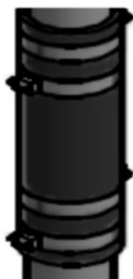
Ilustrație 178: Cleme montate
