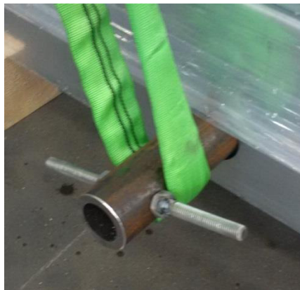
Ilustrație 23: Asigurarea împotriva alunecării echipamentului de încărcare
