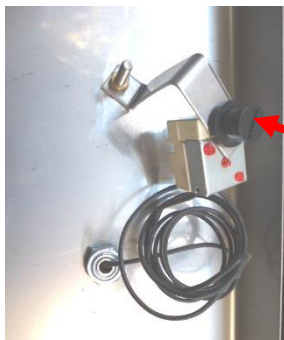
Ilustrație 199: Termostat ca capac pe butonul de resetare
