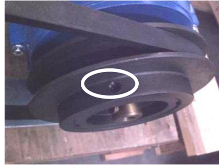
Ilustrație 217: Poziția șuruburilor Allen pe fuliile variabile
