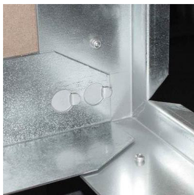
Ilustrație 153: Attaching the brackets
