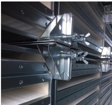
Ilustrație 157: Dispozitiv de strângere cu placă de presiune din tablă
