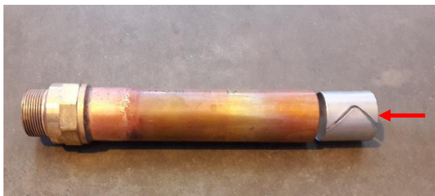
Ilustrație 168: conducta de cupru cu inel de armare
