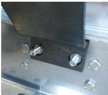
Ilustrație 25: Pozitionarea urechilor de suspendare pe rama de baza a monoblocului
