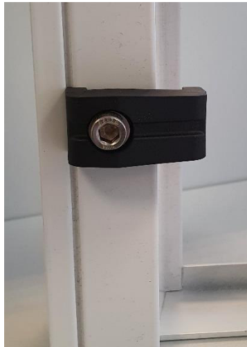
Ilustrație 133: Mecanism de fixare pe cadrul ușii (ZIB)
