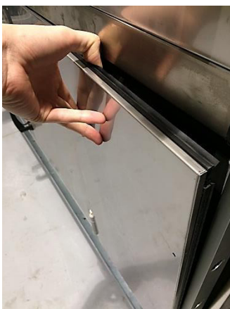
Ilustrație 89: Introducerea panoului exterior
