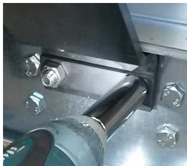
Ilustrație 26: Fixarea foii metalice și a urechii de ridicare cu piulițe la monobloc
