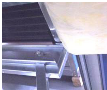
Ilustrație 145: Glisați filtrele
