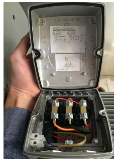
Ilustrație 193: Motor terminal box
