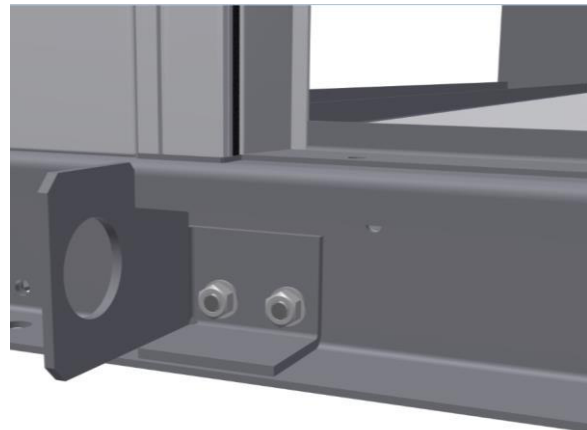
Рисунок 11: подъемные проушины установлены
