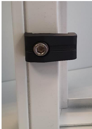
Рисунок 40: фиксирующий механизм на дверной раме (ZIB)
