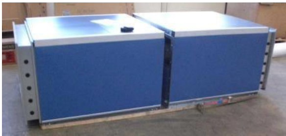
Рисунок 22: Объединение секций СКВ
