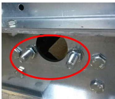
Рисунок 24: Заводская подготовка для моноблочных подъемных проушин
