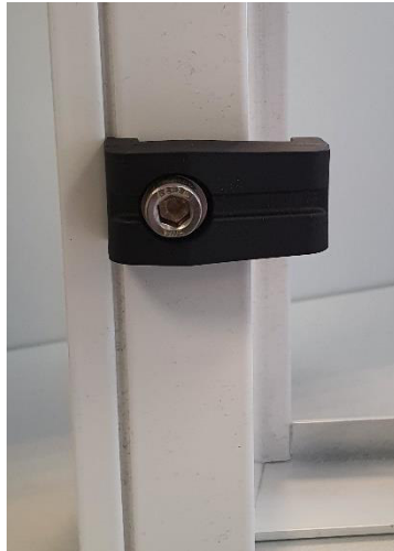
Рисунок 134: фиксирующий механизм на дверной раме (ZIB)
