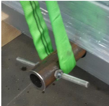
Рисунок 23: Защита от соскальзывания с грузонесущего оборудования
