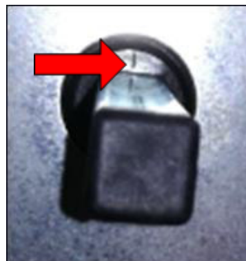
Рисунок 139: на закрытое положение указывает маркировка на шестерне
