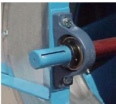
Рисунок 222: Подшипник вентилятора со смазочным ниппелем (пример Comefri NTHZ)
