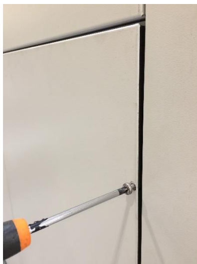
Рисунок 131: снятие дверной панели (TRA-E) от дверной рамы
