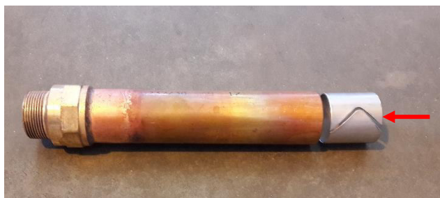
Рисунок 169: медная труба с усиливающим кольцом
