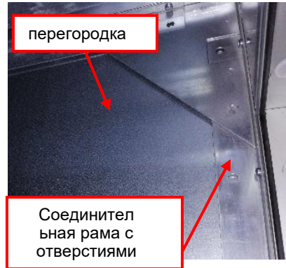
Рисунок 85: Соединительная рама и разделительная перегородка (еще не прикручено)
