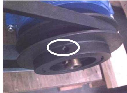
**Figura 224:** Posición de los tornillos Allen en poleas variables
