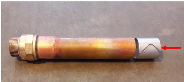
**Figura 171:** Tubería de cobre con anillo de refuerzo
