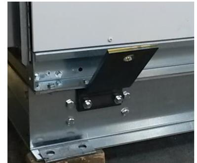
**Figura 29:** Argollas para grúas del monobloque instaladas.
