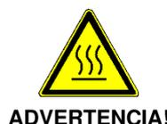
Por los vapores calientes hay riesgo de quemaduras. Por ello, asegúrese de que no hay presión de vapor y que el sistema se ha enfriado antes de trabajar en las tuberías de vapor.
