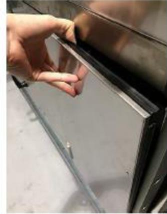
**Figura 58:** Eliminación de los paneles externos
