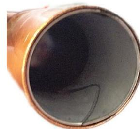
**Figura 172:** Tubería de cobre con el anillo de refuerzo insertado
