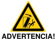
Preste atención a los paneles de las puertas extraíbles, ya que después de deshacer la conexión pueden caer y provocar heridas. Por ello, ¡use siempre ambas manos para fijar, deshacer o manipular los paneles de la puerta!
