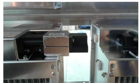
**Figura 165:** Conexión enchufable de filtros electrostáticos
