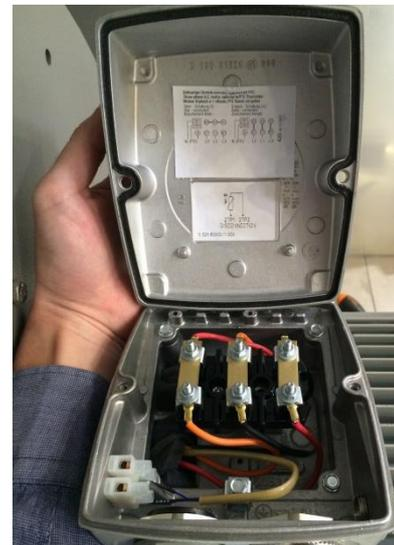
**Figura 200:** Caja de terminales del motor
