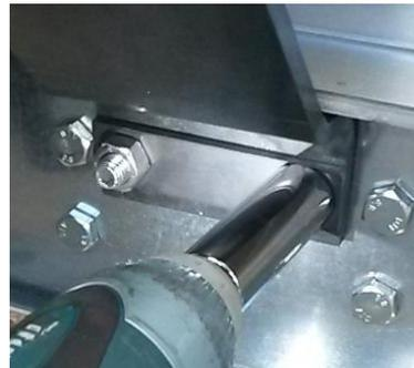
**Figura 28:** Sujeción de la lámina de metal y de las argollas de elevación para grúa con tuercas.
