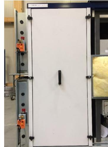
**Figura 137:** Panel de puerta (ZIB) montado
