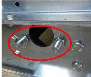
**Figura 26:** Argollas para elevación de monobloque realizadas en la fábrica
