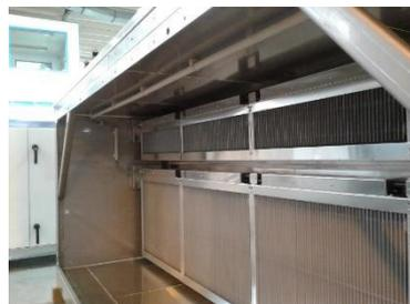
**Figura 164:** Filtros electrostáticos en la carcasa
