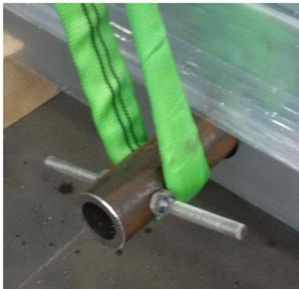
**Figura 25:** Aseguramiento frente a deslizamientos de la carga de la elevación
