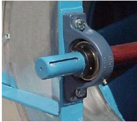
Resim 221: Gres nipelli fan rulmanı (örnek Comefri NTHZ)
