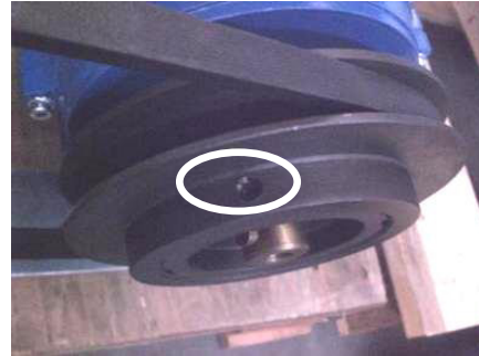
Resim 219: Alyan vidalarının değişken çaplı kasnaklardaki yeri
