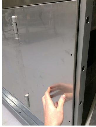
Resim 54: Vidaları çıkarılmış dış panel
