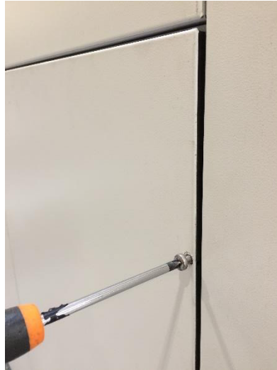
Resim 130: Vidayı çıkararak kapı panelinin (TRA-E) çerçeveden sökülmesi
