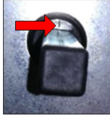
Resim 138: Kapalı konum, dişli çarktaki işarette gösterilir
