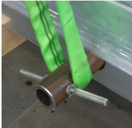
Resim 23: Kaldırma ekipmanının kaymaya karşı korunması
