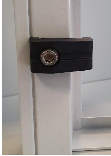
Resim 133: Kapı çerçevesine sabitleme mekanizması (ZIB)
