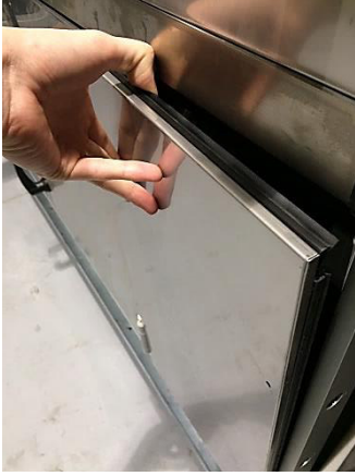
Resim 89: Dış panelin takılması
