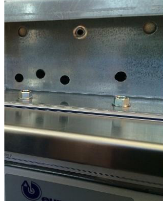
Resim 82: Çift katlı ünitelerin üst üste bağlanması
