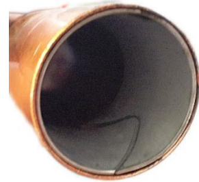
Resim 169: Takviye halkasının boruya takılmış hali
