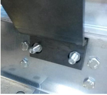
Resim 25: Yekpare mapanın çerçeve üzerindeki konumu
